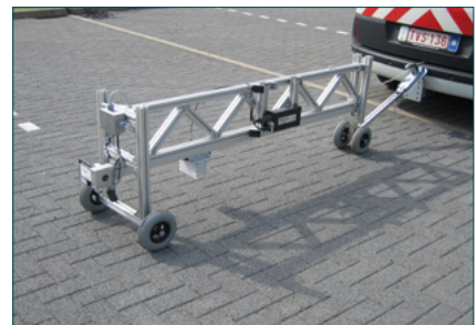
Figure 3 – Configuration dynamique d'un profilomètre laser (à gauche; le laser et la caméra se trouvent dans le petit bac blanc) et dans sa configuration statique (à droite)
