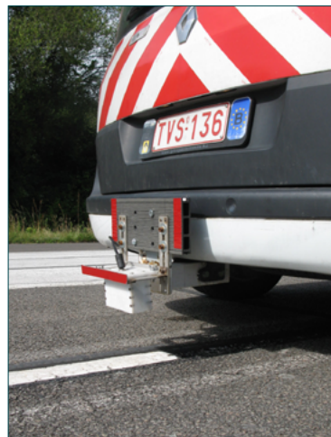
Figure 3 – Configuration dynamique d'un profilomètre laser (à gauche; le laser et la caméra se trouvent dans le petit bac blanc) et dans sa configuration statique (à droite)
