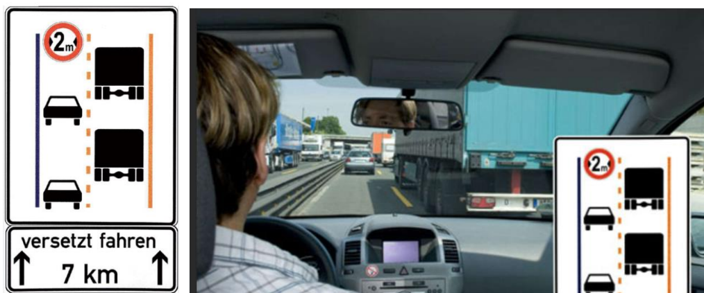
Figure 51 – Exemples de panneaux avec réduction largeur bande et exemple d'une largeur de véhicule yc rétroviseurs (Source : 24auto.de)
