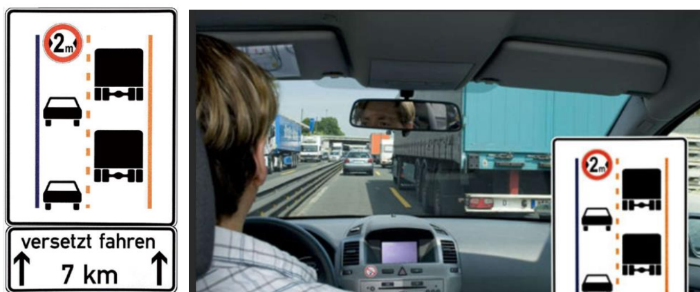
Figuur 51 - Voorbeelden van panelen met versmalling van de rijstrook en voorbeeld van een voertuigbreedte (incl. achteruitkijkspiegels (Bron: 24auto.de)
